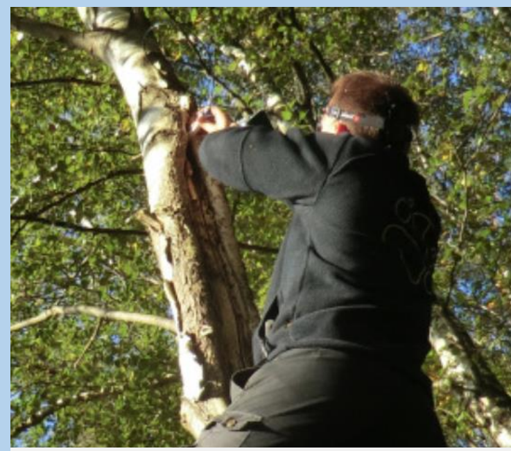
Abb. 2: Besatzkontrolle von Baumhöhlen mittels Videoendoskop
