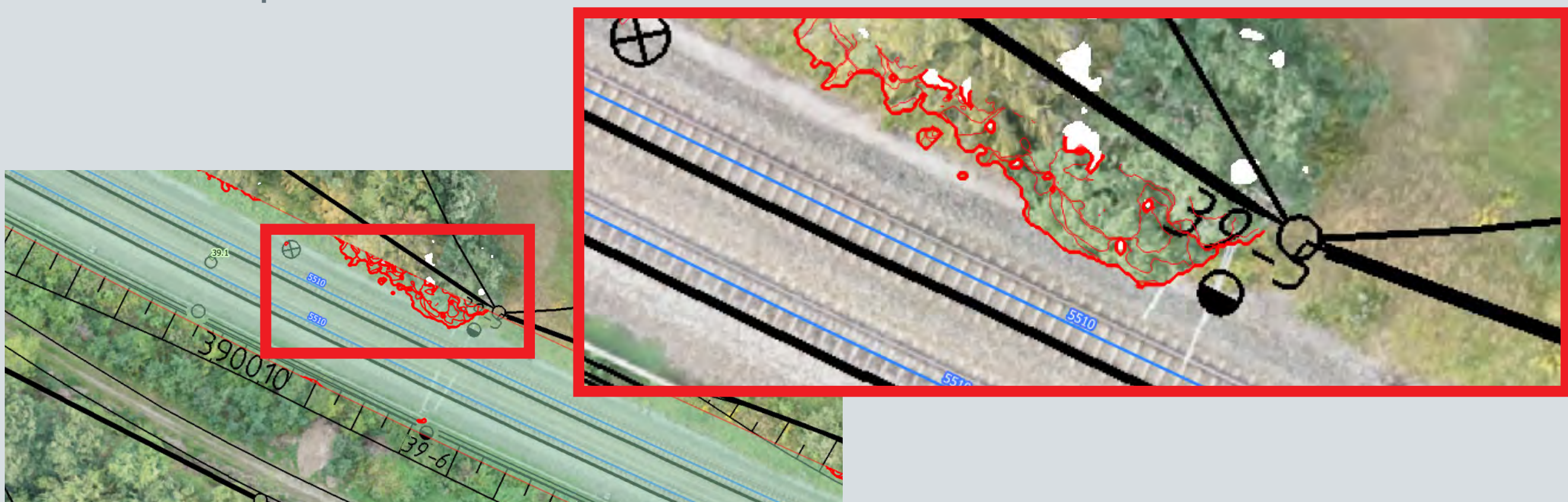
Erkennung von Vegetation im Lichttraumprofil
