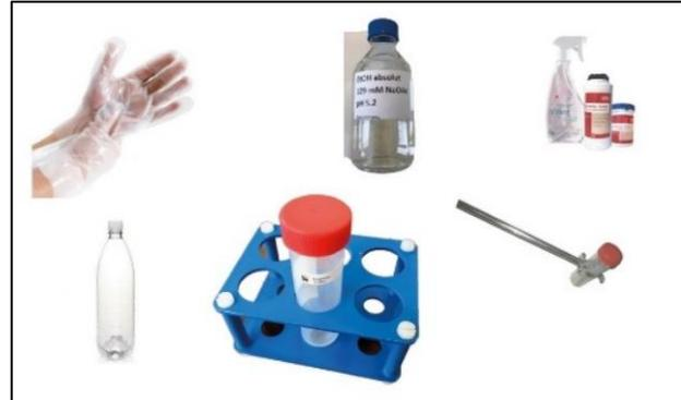
**Abbildung 2: Für die Probenahme wird spezielles Feldmaterial bzw. werden spezifische Chemikalien benötigt. Dabei wird der Verwendung von «Einwegmaterialien» zur Verhinderung von Kontamination besondere Bedeutung beigemessen. (Fotos: ARNAL AG)**
