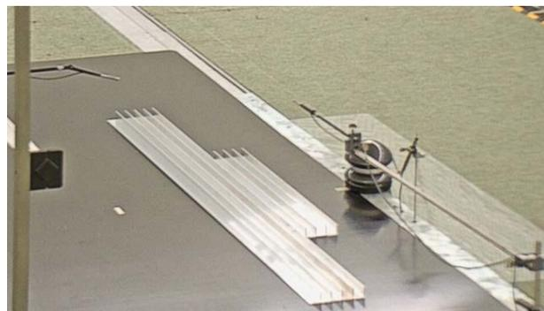
Die Differenz zur Messung ohne Diffraktor ergibt die sogenannte „Einfügedämpfung“.
