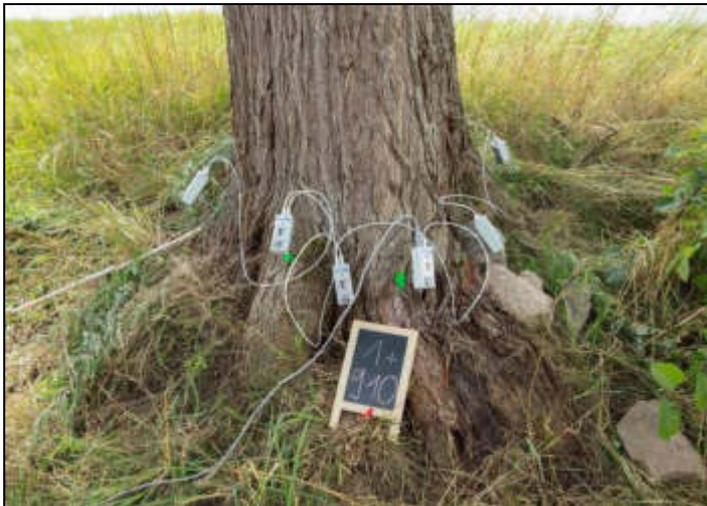
Alleebaum mit montierter Sensorkette an den Wurzelanläufen. Hier wurde untersucht, wie weit sich das Wurzelwerk an der straßenabgewandten Seite ausgebreitet hat.
