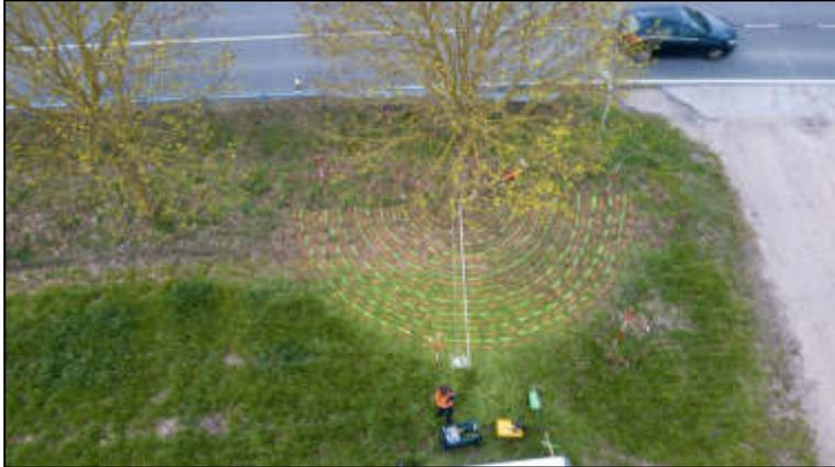
Durch mehrere streifenförmige Parallel- und gegebenenfalls Quermessungen (alternativ auch Fahrten im Halbkreis, siehe Foto) entsteht so an Baumstandorten ein Abbild zur Position und Tiefe des Wurzelwerks.
