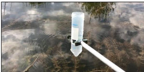
**Abbildung 3: Für beide Methoden erfolgt die Probenahme mit Tube und Probenahmewerkzeug. (Foto: ARNAL AG)**
