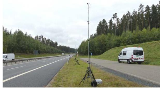
Wenn eine ausreichende große Anzahl von Fahrzeugvorbeifahrten aufgenommen werden, kann eine statistische gut abgesicherte Einfügedämpfung des Diffraktors an den Mikrofonpositionen ermittelt werden.
