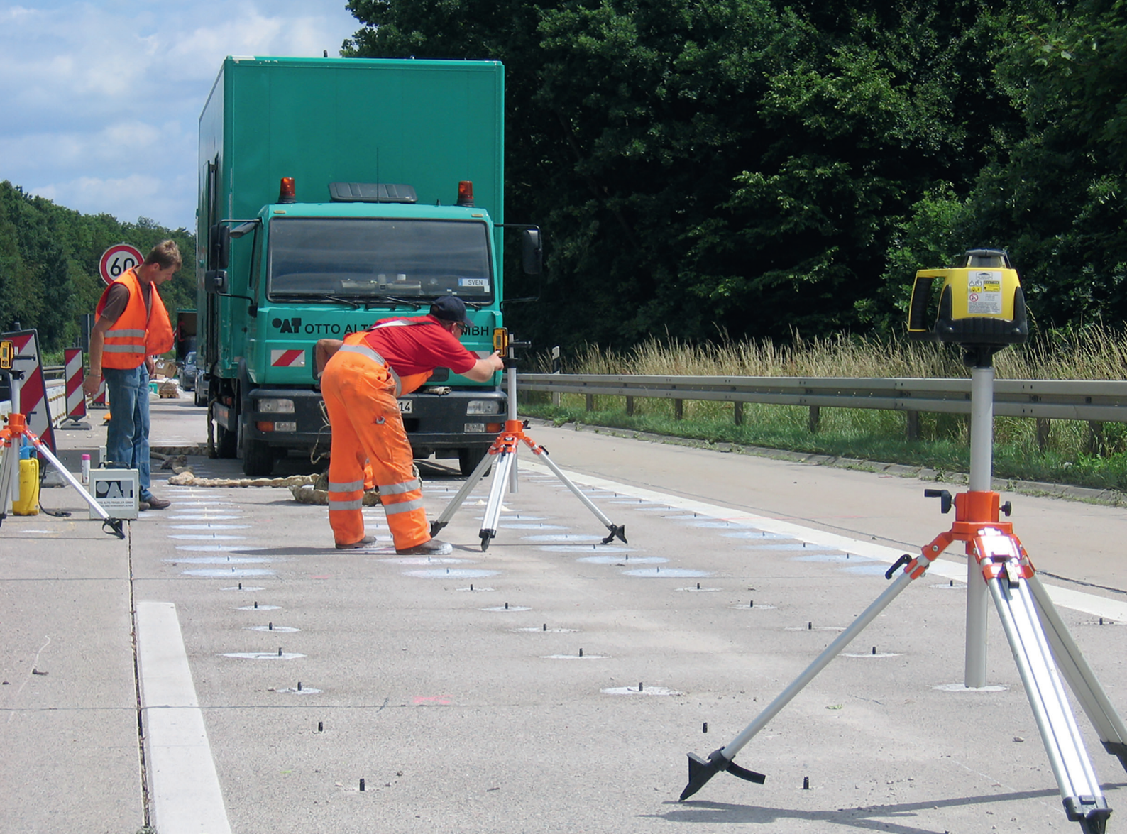
Lageüberwachung mit Lasermesstechnik und Stufenmessgerät
