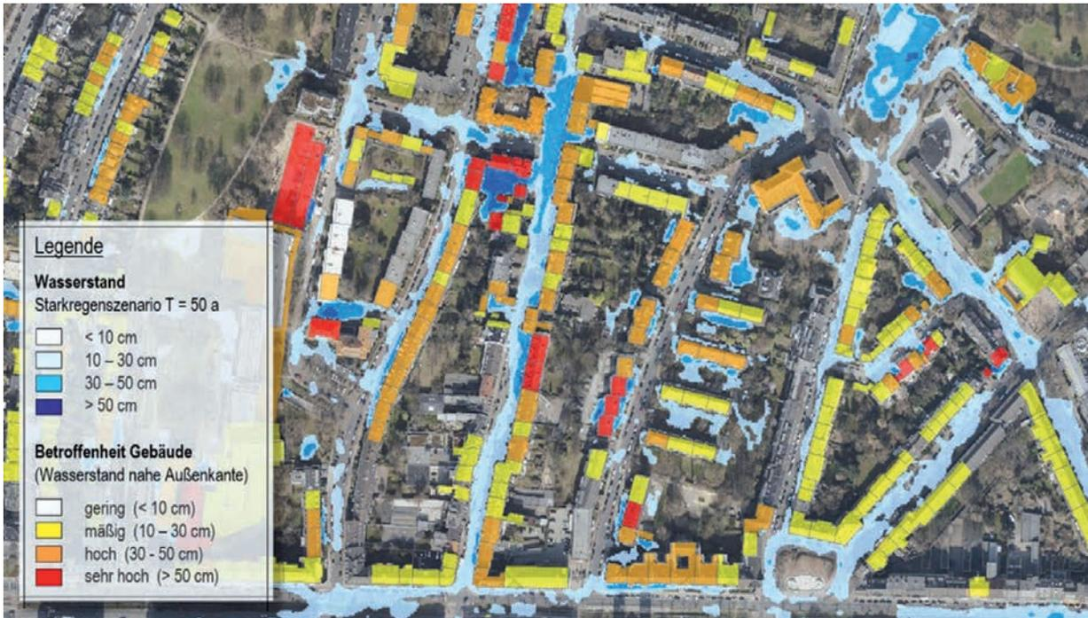
Bild links: Ergebnisdarstellung zur Überflutungssimulation mit Hervorhebung der Gebäudebetroffenheit, Lastfall „Außergewöhnlicher Starkregen“
