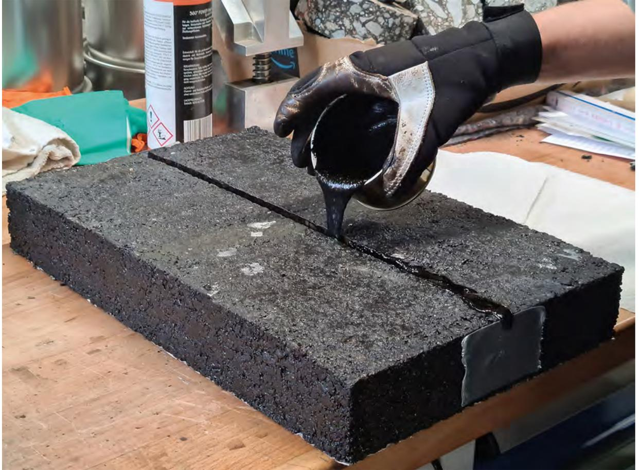
Herstellung einer Asphalt-Probepatte mit Längsfuge und Bitumenheißvergussmasse
