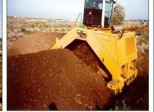
Einsatz Mietenumsetzer zur Homogenisierung und Belüftung des Baggergutes
